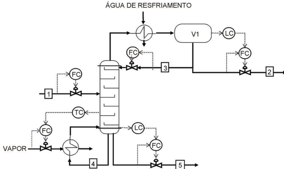
Na coluna representada na Figura, não havendo mudança de *set points* em relação à condição normal de operação, o resultado de um cenário de inundação da coluna tipicamente leva o operador a observar um
